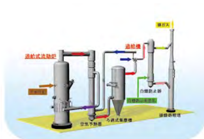
図-8 過給式流動焼却炉の技術概要
