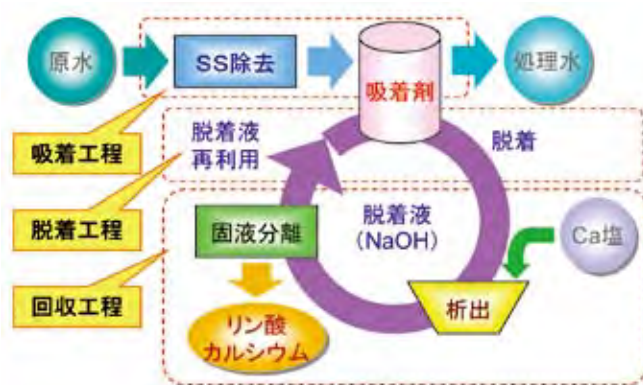
図-4 リン除去・回収技術のフロー図
