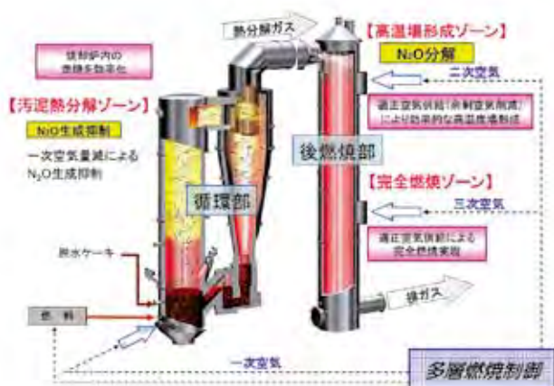
図－6 循環式流動焼却炉の改良型の技術概要
