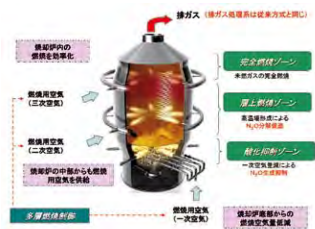
図-7 気泡式流動焼却炉の改良型の技術概要
