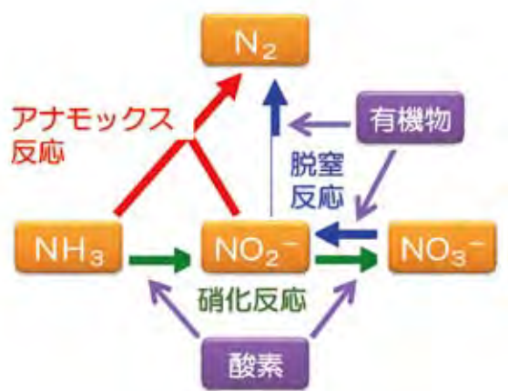
図-3 アナモックス反応の概念図
