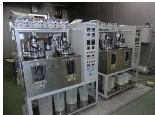
連続式消化試験装置（2連×2基）
