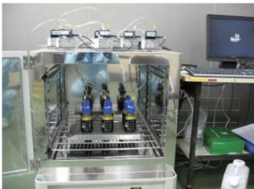
回分式嫌気性消化試験装置（6連）
