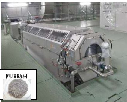
汚泥脱水施設の汚泥処分コストの縮減のため、流入下水から回収した繊維状物を脱水助剤として用いる新技術の導入を提案
