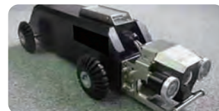
管路施設の内部の状態を確認できるテレビカメラ
