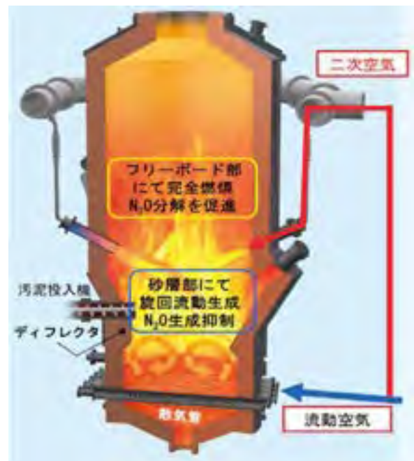
図-2 二段燃焼式旋回流動炉の概要
