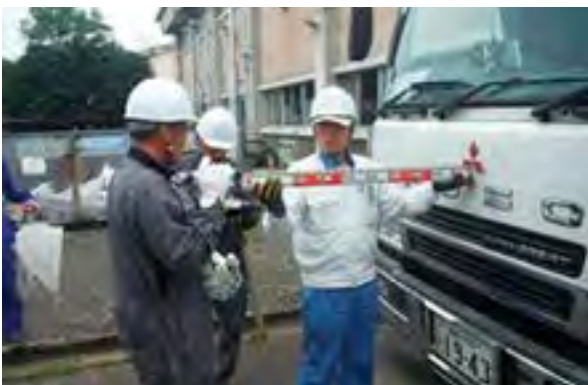
図6 搬送トラック周り線量測定
