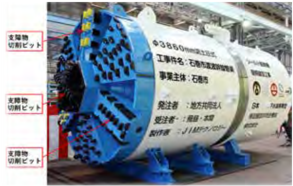
写真-2 シールドマシン製作完了
