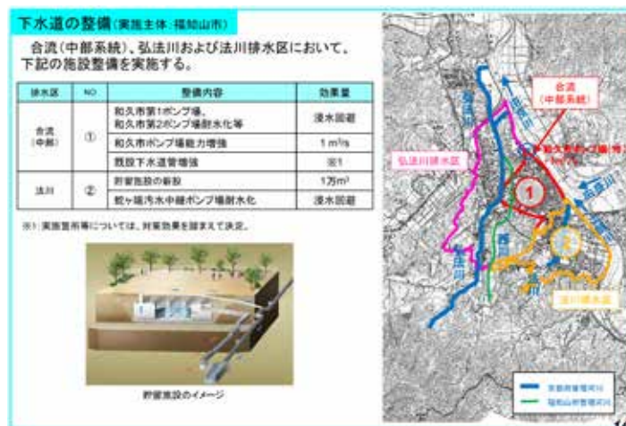
雨水貯留施設の整備、排水機場の増強(ハード対策)
