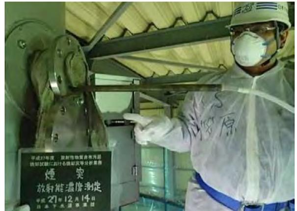
排ガス中の放射能濃度分析のためガスを採取する小笠原さん(県中)
