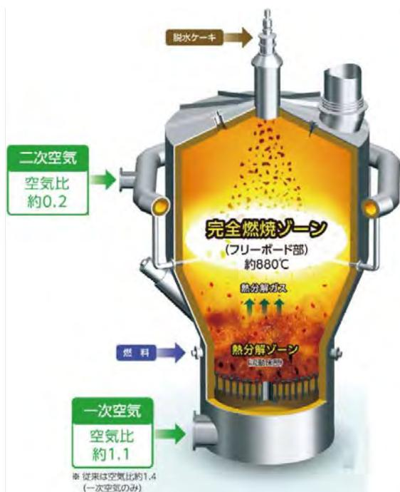
図2 気泡式高効率二段燃焼炉の構造
