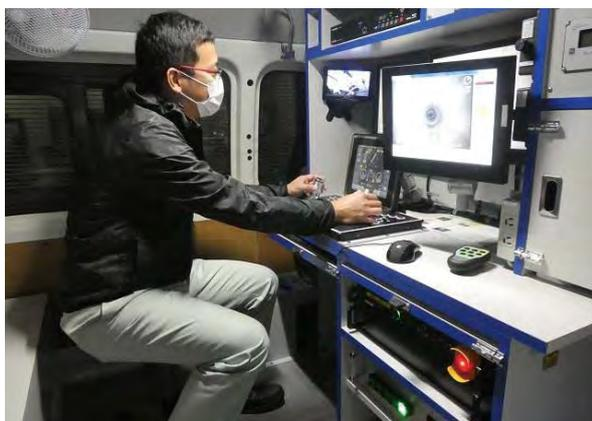
管きよの点検調査実習 (TV カメラ車操作)
