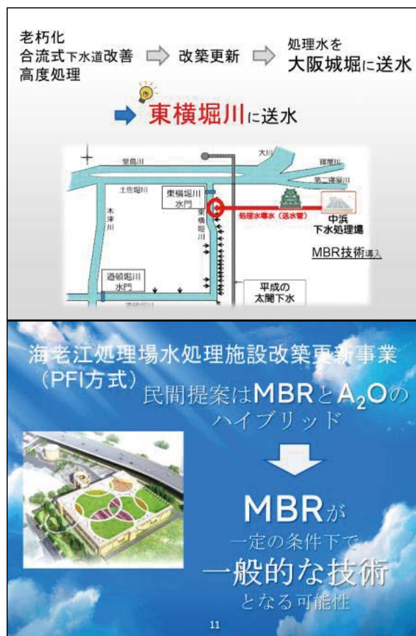
図4 大阪市におけるMBRの導入事例 (CWO 城居常務 情報提供 資料)
