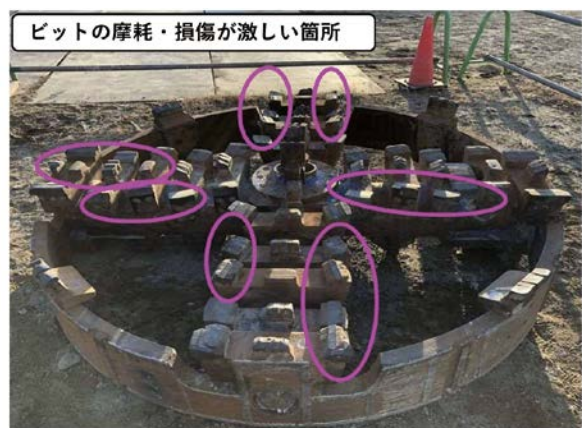
図10 ビット摩耗状況
