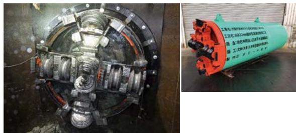
写真3 岩盤対応型ヘッド搭載の推進工法の採用（硬質地盤対応）
