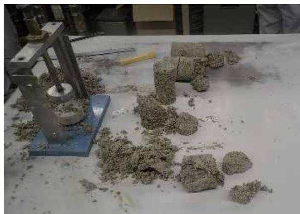
写真7 試験施工のボーリングサンプリングの供試体崩壊状況
