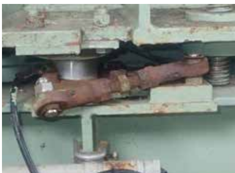
写真4 ケーキ貯留ホッパのロードセル破損
