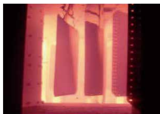
写真1 グラスライニングパネルの焼成状況
