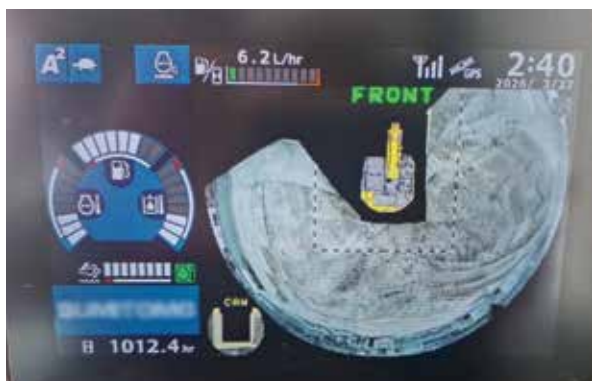
写真2 カメラ付きバックホウ カメラ映像
