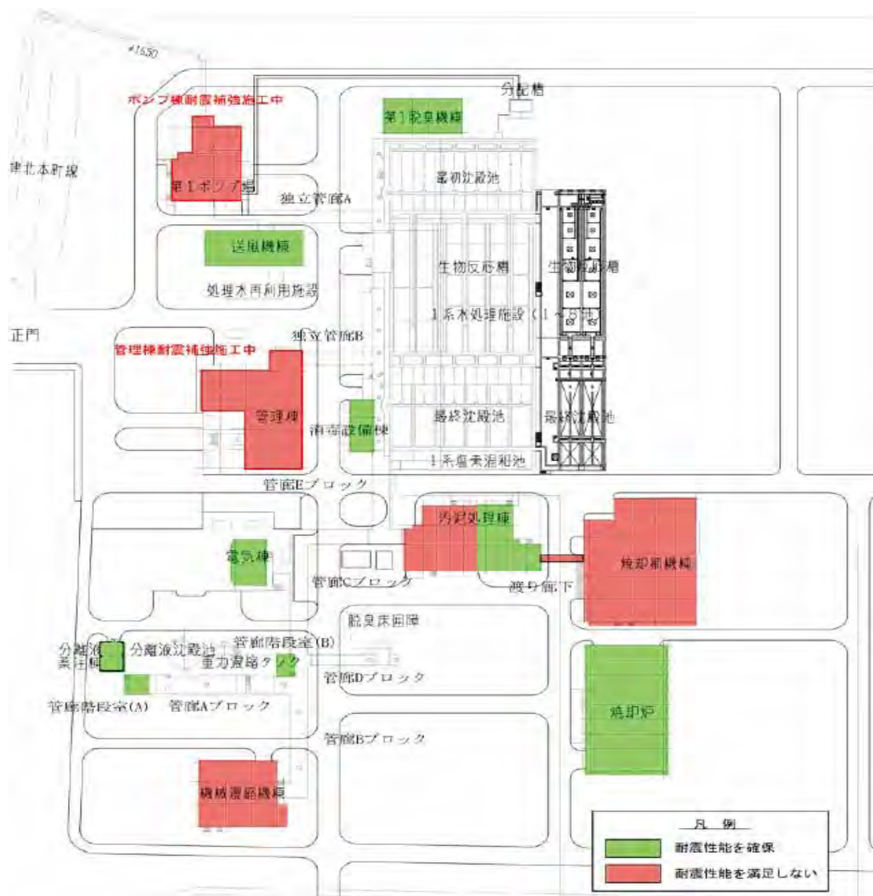
図-1 建築施設の耐震性
