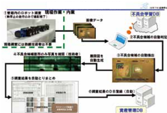
図-6 新型ロボットで調査フロー
