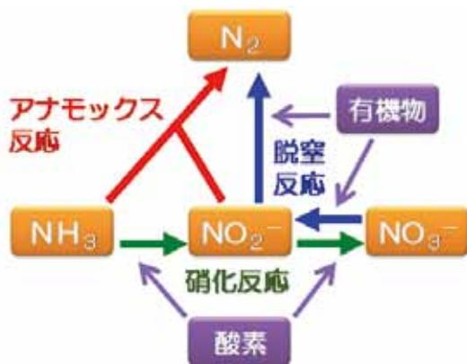
図-4 アナモックス反応の模式図
