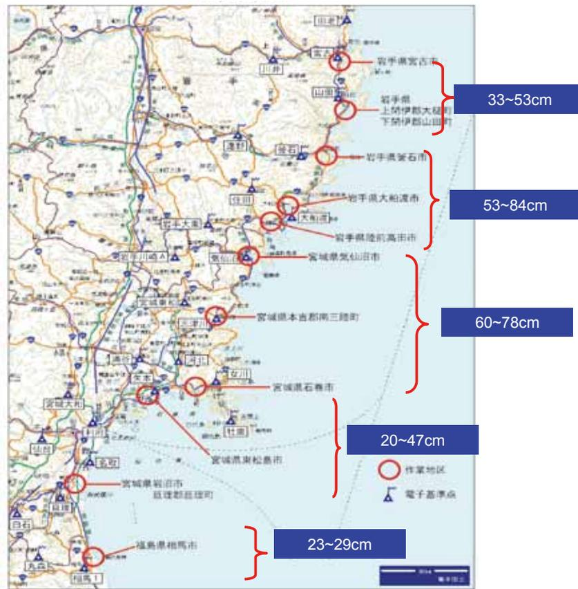
図-1 各地での地盤沈下状況
