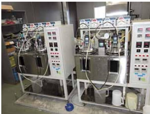
図-5 嫌気性消化実験装置 (J S 実験施設内)
