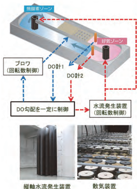
図-2 二点DO制御システム
