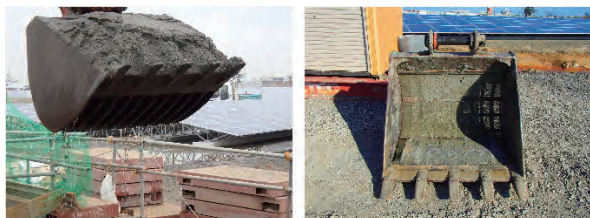
写真－4 掘削機械に水切りのできるバケットに改造
