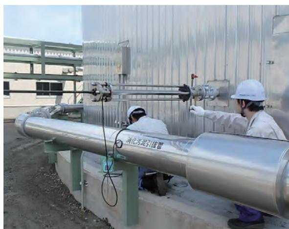
写真-4 流速測定装置による測定状況
