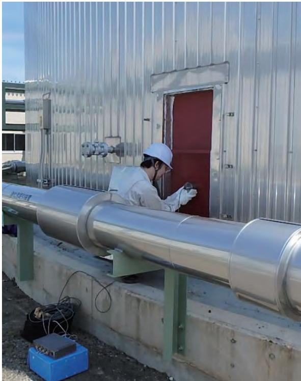
写真-5 堆積物センサーによる測定状況
