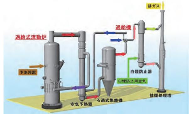
図3 過給式流動焼却システムの概要
