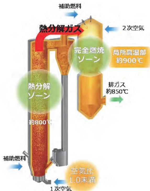
図6 高効率二段燃焼汚泥焼却炉の概要
