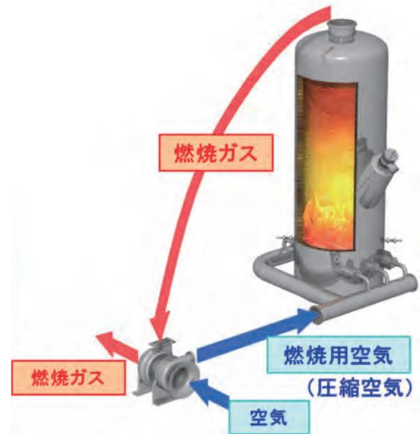
図4 過給機廻りの概念図
