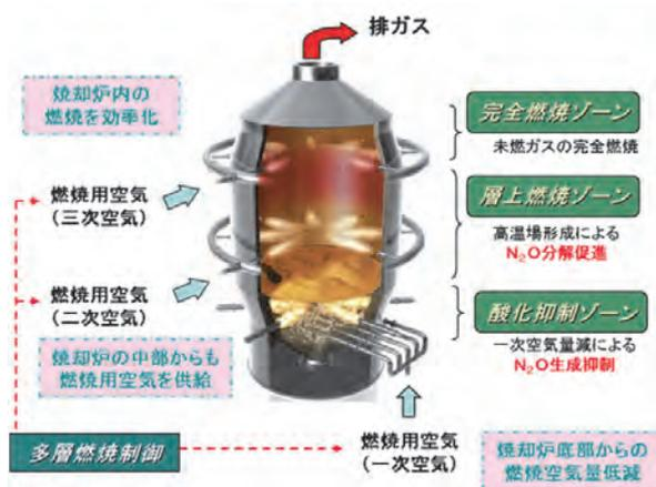
図2 多層燃焼流動炉の概要
