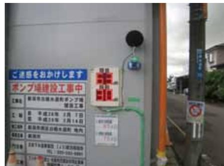
写真-12 振動・騒音計測状況
