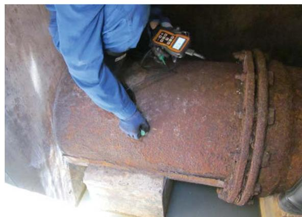
圧送管渠の超音波管厚調査
