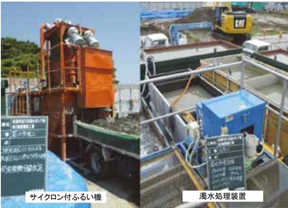
写真-3 排水処理装置
