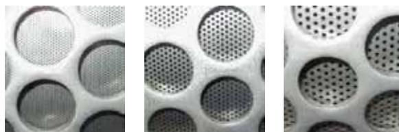
図-7 脱水部スクリーン面
