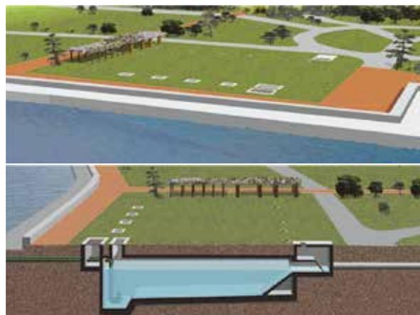
図-3 浪打浜雨水ポンプ場 鳥瞰図・断面図
