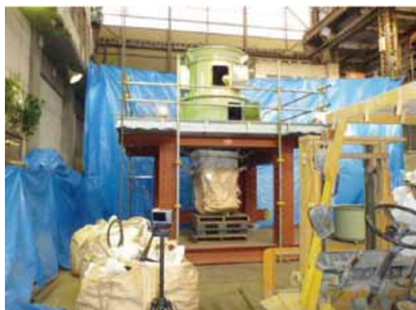
写真5 フレキシブルコンテナ開袋試験
