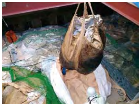
写真3 反応槽内フレキシブルコンテナ吊上げ試験
