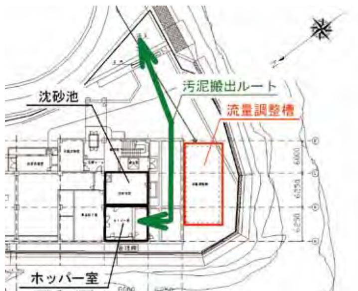
図-2 施設配置及び汚泥搬出ルート図
