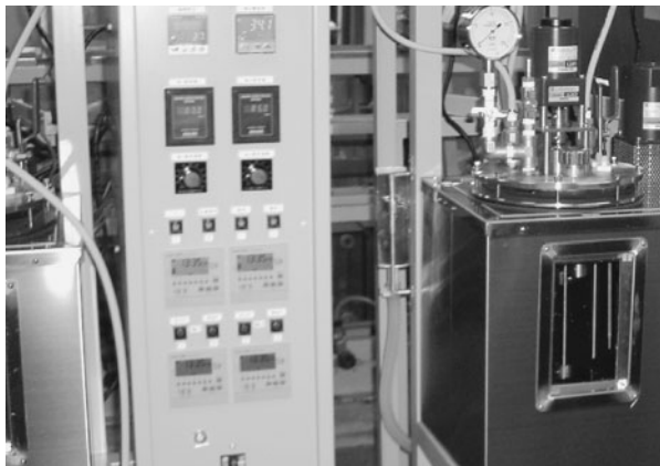
写真－2 超高速嫌気性消化の実証プラント (千葉県市原市内)
