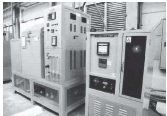
写真-1 エイジトロン（コンクリート腐食促進装置）
