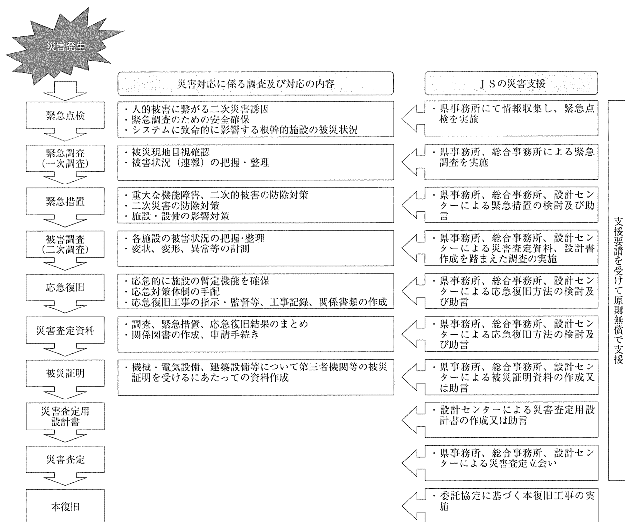
図－１ 災害復旧の進め方と J S の支援（処理場・ポンプ場）
