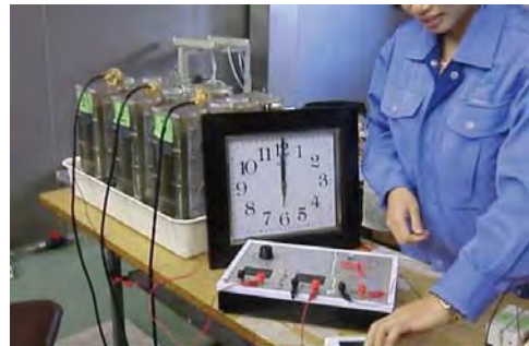
写真1 壁掛時計電源としての実験
