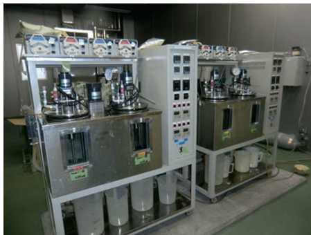
図3-1 連続消化実験装置の外観
