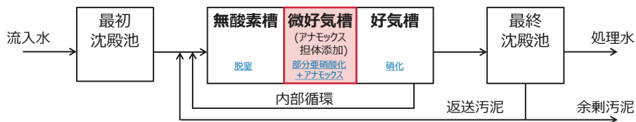
図2-17 MLE+アナモックス法の処理フロー
