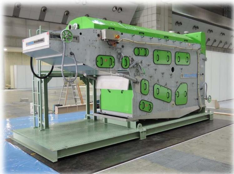
写真 難脱水性汚泥対応型ベルトプレス脱水機
