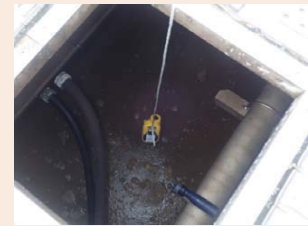
劣化環境調査の例（炭酸ガス測定）
