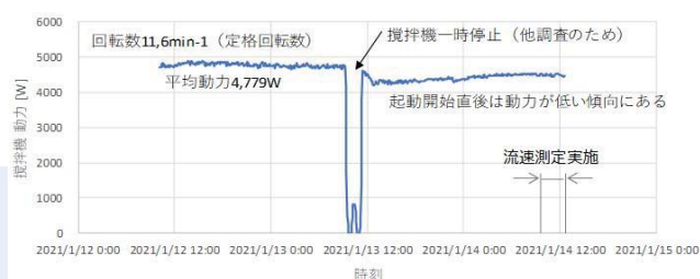
インペラ式攪拌機動力測定結果 (2021年1月)
