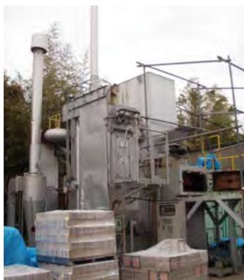
燃焼試験装置(バイオマスボイラー)
