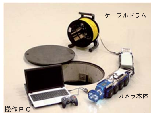
図-1 調査機材一式 小型・軽量で可搬性に優れた最小構成
