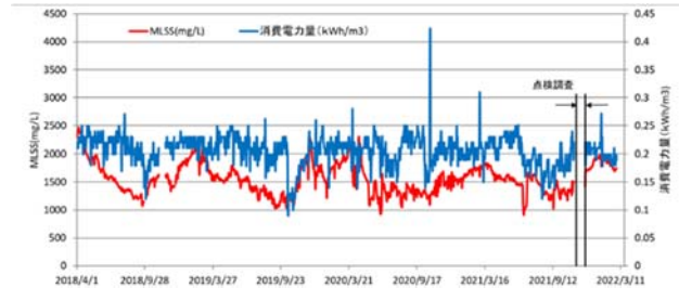
図-2 MLSS 濃度と反応タンク消費電力量の推移（省エネ運転期間）
