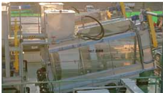
▲高濃度濃縮装置
