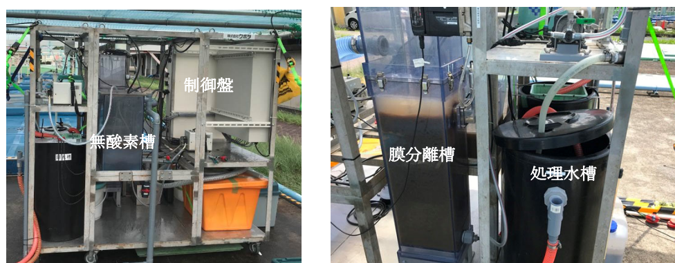
図3 小型 MBR 実験装置外観
