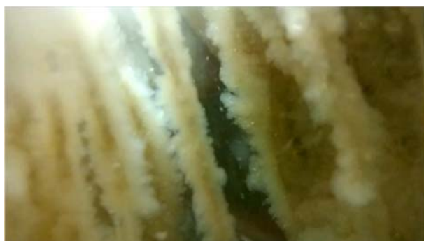
図1 ガス透過性膜表面に形成された生物膜
