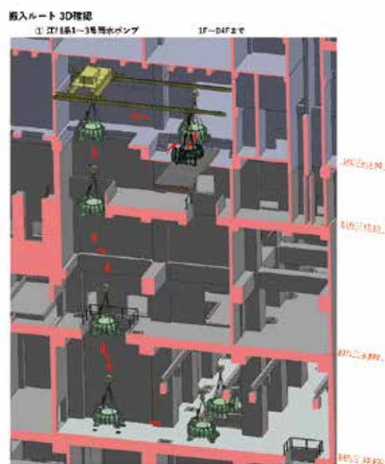
図8 3Dモデルによるポンプの搬入計画
