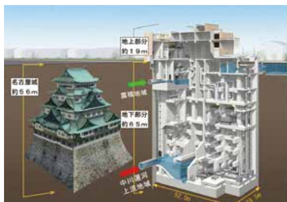
図2 ポンプ所躯体と名古屋城
