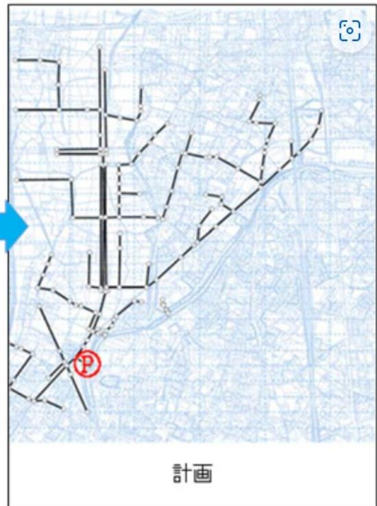
5年確率で策定した既存水路および雨水ポンプ場計画を、複数の計画降雨・実降雨、更に整備段階に応じて、浸水シミュレーションを実施
