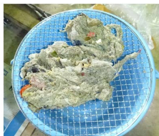
従来の除塵機で掻き揚げたしさ
