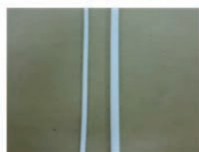
写真左：細径PVDF中空糸膜(外径1.65mm) 写真右：従来型PVD中空糸膜(外径2.8mm)
