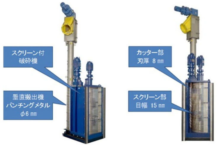
破碎・脱水機構付き垂直スクリー式除塵機の外観
