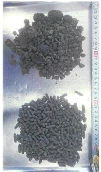
炭化物の写真(上)とペレット化した炭化物の写真(下)
