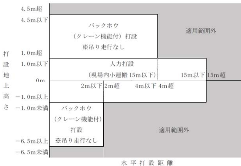
図3-1 コンクリート打設工法の選定
