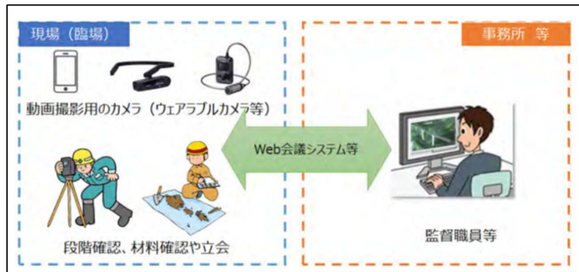
図2 遠隔臨場の機器構成 (例) 出典：国土交通省 HP
