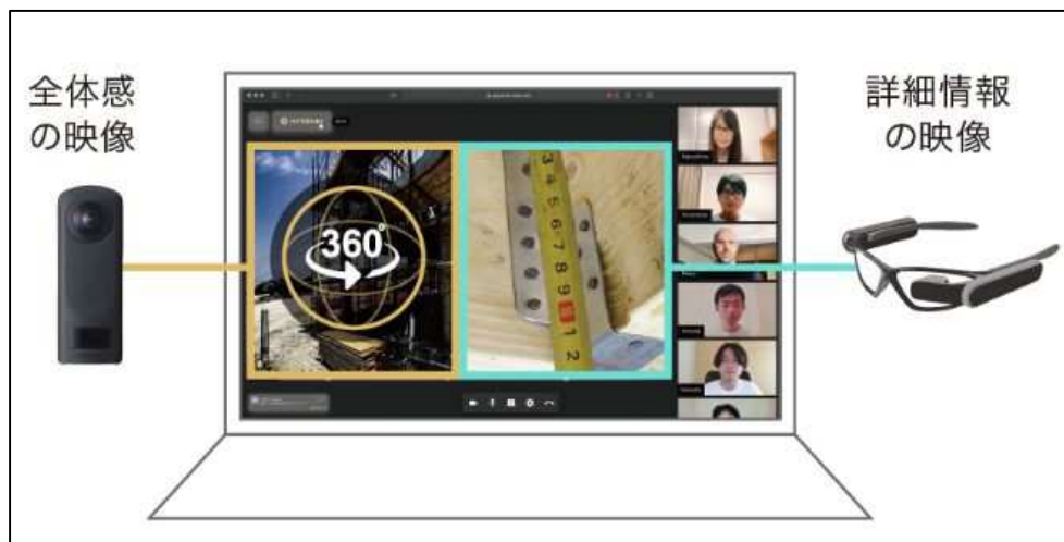
図 1 360 度映像を用いた遠隔臨場 出典：Ricoh 説明資料を一部編集
