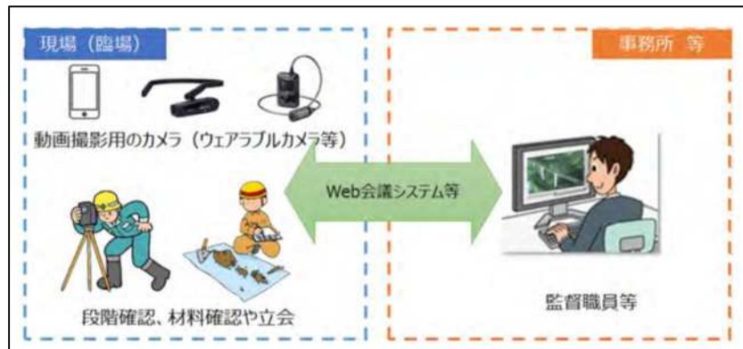
図 2 遠隔臨場の機器構成 (例)
