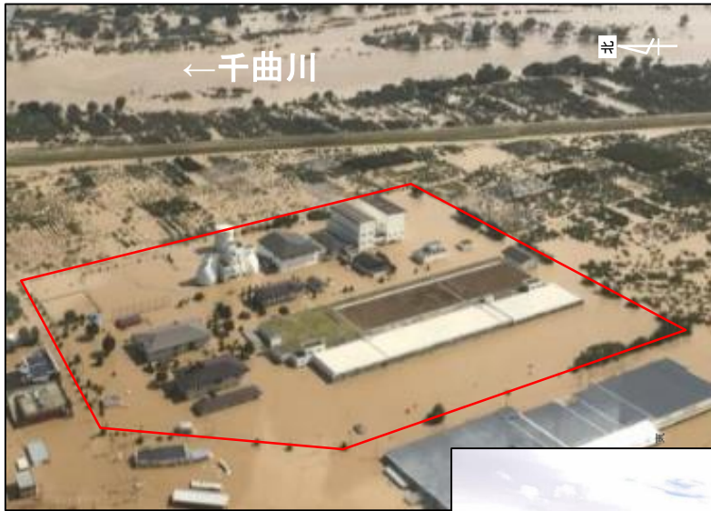
↑ 千曲川流域下水道下流処理区終末処理場の浸水状況（航空写真）
