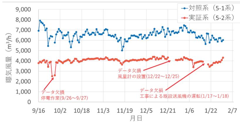
図2-31 実証系と対照系の曝気風量の推移
