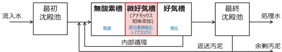
図2-22 MLE＋アナモックス法の処理フロー
