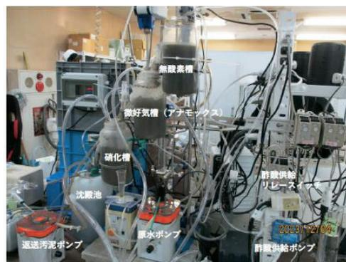
図2-23 MLE+アナモックス法のラボ実験装置のフローおよび外観
