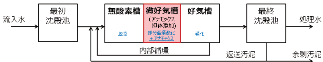
図 2-1 MLE+アナモックス法の処理フロー
