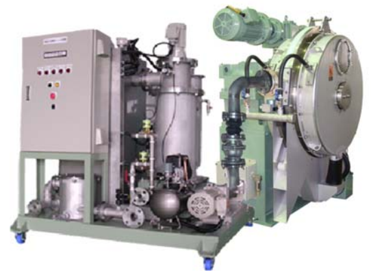
回転加圧脱水機Ⅳ型
